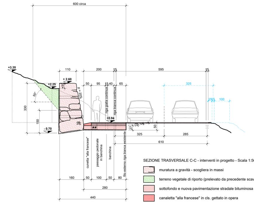
SEZIONE TRASVERSALE C-C - interventi in progetto - Scala 1:50
