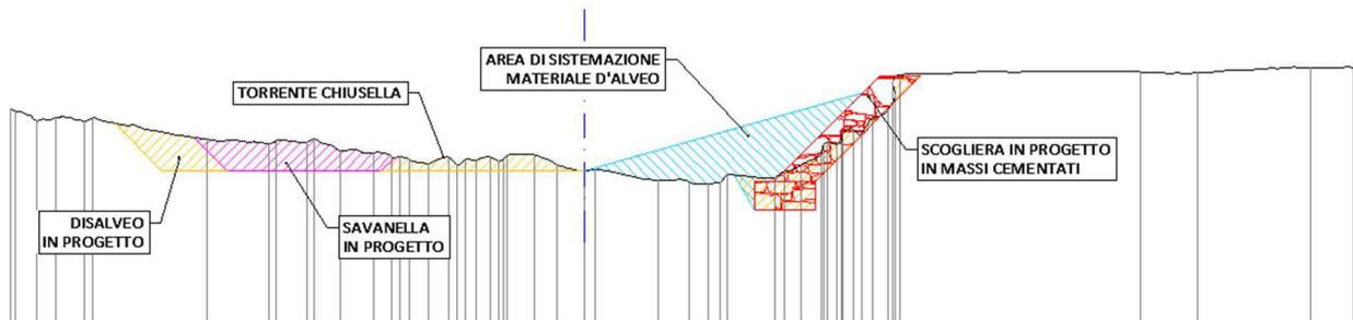
Figura 13. Sezione generica per il modello di calcolo
