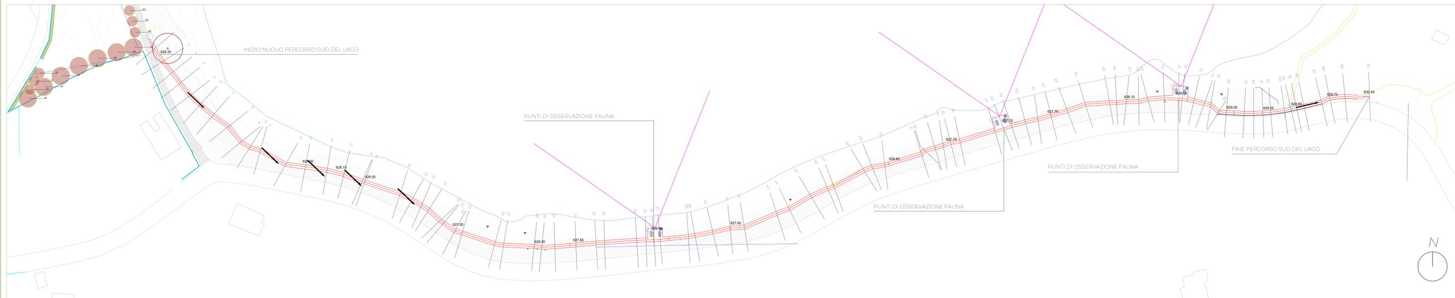
DETTAGLIO PALIZZATA h=0.15 m - sezz. 1-51-77    DETTAGLIO PALIZZATA h=0.25 m - sezz. 43-78-81    DETTAGLIO PALIZZATA h=0.30 m - sezz. 15-19-20-34-46-47-82    DETTAGLIO PALIZZATA h=0.35 m - sezz. 2-18-21-28-29-44-45-80-87    DETTAGLIO PALIZZATA h=0.40 m - sezz. 9-11-30-31-32-33-35-41-57-62    DETTAGLIO PALIZZATA h=0.45 m - sezz. 10-12-17-22-24-25-26-27-36-40    DETTAGLIO PALIZZATA h=0.50 m - sezz. 8-13-14-16-52-56-58-59-63-73-74-79
