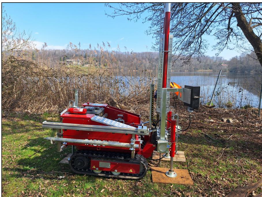
*Foto 4: fase di realizzazione della prova DPSH4*
