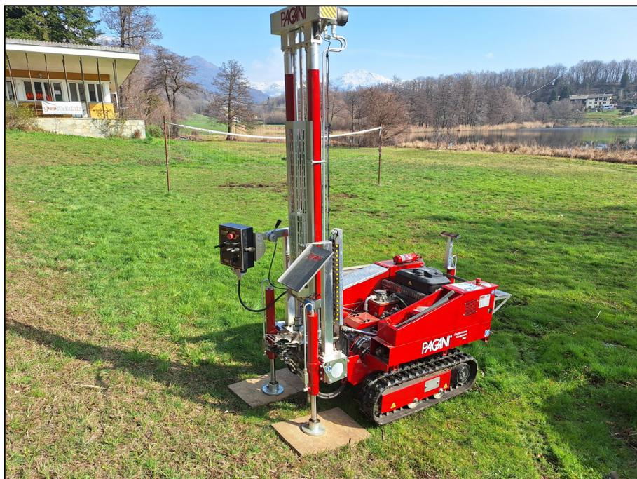
*Foto 1: fase di realizzazione della prova DPSH1*
