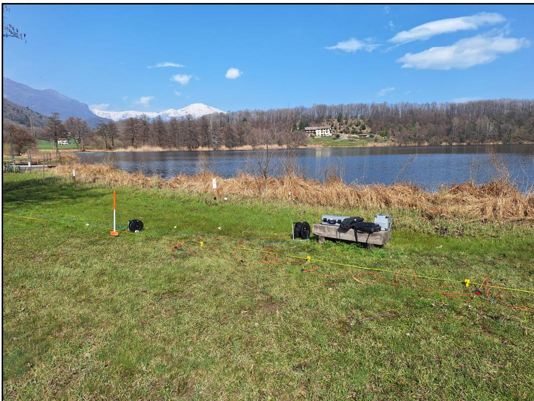
*Foto 1: stendimento sismico effettuato.*
