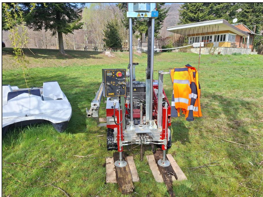
*Foto 2: fase di realizzazione della prova DPSH2*
