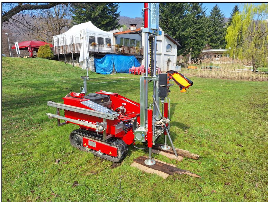
*Foto 3: fase di realizzazione della prova DPSH3*
